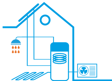
Kompaktní jednotka s integrovanou nádrží ECH 2 O stojící na podlaze
